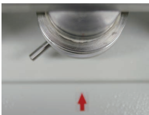
Zum Schluss wird das Gewicht angehoben und übt keine Kraft mehr auf den Teig aus. Die Probe relaxiert, schnurrt in diesem Moment je nach ihrer Elastizität.
