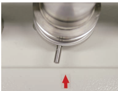
Je nach Kleberqualität dehnt die konstante Kraft (Scherspannung) die Probe mehr oder weniger. Die untere Platte wird entsprechend schnell gegen die obere ausgeleitet. Diese Auslenkung bzw. der Scherwinkel wird zeitabhängig aufgezeichnet.
