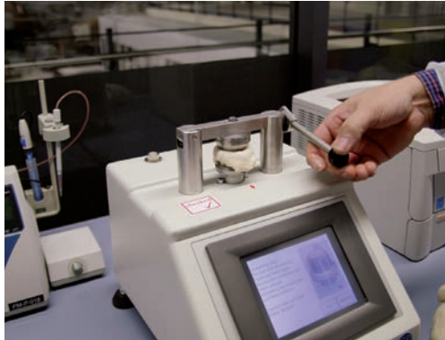
Vorbereitung der Messung: Die Teigprobe wird am besten mit der Schere aus dem Teig herausgeschnitten, damit keine äußere Haut das Messergebnis beeinflusst. Mit einem Messerring schneidet man den überstehenden Teigrest ab.
