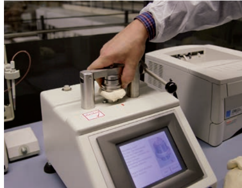
Vorbereitung der Messung: Die Teigprobe wird am besten mit der Schere aus dem Teig herausgeschnitten, damit keine äußere Haut das Messergebnis beeinflusst. Mit einem Messerring schneidet man den überstehenden Teigrest ab.
