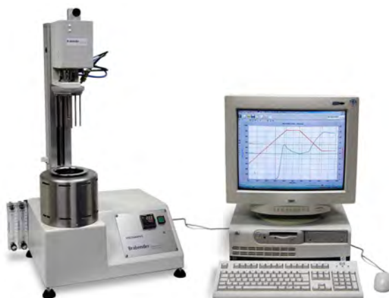
Иллюстрация 2: Вискограф-Е (Viskograph-E)
