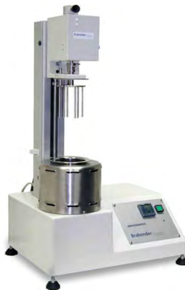
Иллюстрация 1: Амилограф-Е (Amylograph-E)
